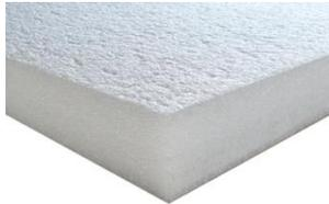
Die geschlossenzellige Polyethylen-Schaum-Platte ist ein optimaler Schutz gegen aufsteigende Erddämpfe in der Kabine. Gefertigt aus Stratocell S FCKW-frei. Wasseraufnahme nach 24h vol% 0.7 DIN 53428. Arbeitstemperaturbereich -30 bis +80 Grad C.
