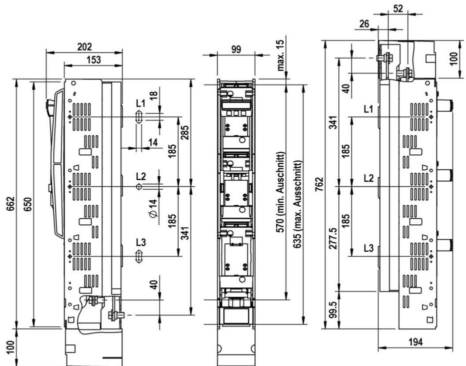
**DIN3 910A / 1250A Aufbau Sicherungslastschaltleiste Fuchs-185:
