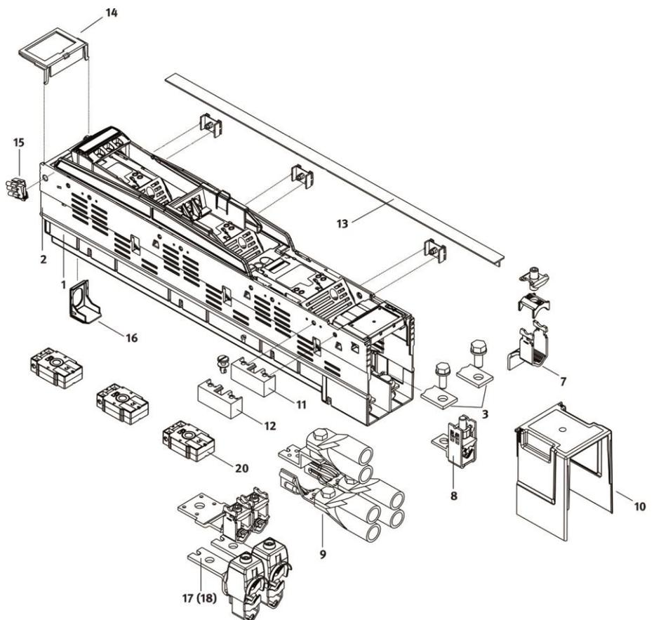
**DIN3 910A / 1250A Aufbau Sicherungslastschaltleiste Fuchs-185:
