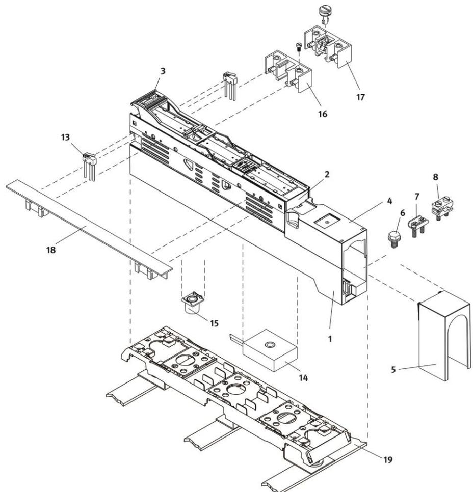
**DIN 00 Sicherungslastschaltleiste Fuchs-185**
